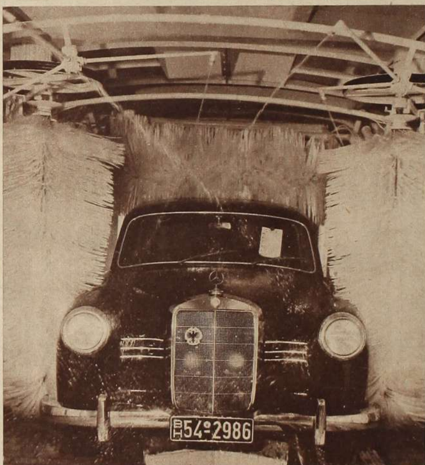
Aus dem „Tunnel Emanuel“ kam dieser Wagen per Förderband soeben in die neue Waschanlage einer Hamburger Parkgarage. Auf dem 12 Minuten lang dauernden Weg wird Staub gesaugt, Wagen gewaschen, getrocknet und geledert, Reifendruck geprüft, Kühlwasserstand kontrolliert und eine Prise Tannennadelduft verabreicht — gegen Benzingeruch.
