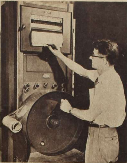
Bis auf ein tausendstel Zoll kann mit Hilfe dieses, mit Atomstrahlen arbeitenden Meßgerätes die Dicke des Plastikfilms festgestellt werden.
