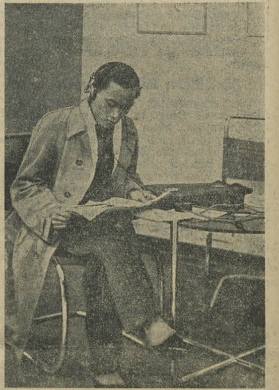
Das Westentaschenradio ist beim Völkerbund in Genf eingeführt worden. Als Antenne dienen ein paar um den Leib geschaltete Drahtwindungen. Auf diese Weise können die Völkerbundvertreter die im Verhandlungsraum gehaltenen Reden auch dann hören, wenn sie sich nicht im Saal aufhalten.
