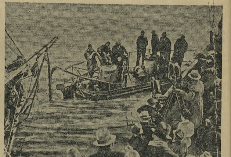
Ein neuartiges kleines Tauchboot hat der amerikanische Ingenieur Lake erbaut. Es ist nur sechseinhalb Meter lang und zwei Meter breit. Das Tauchboot heißt „Explorer“ und dient zum Heben wertvoller Dinge aus gesunkenen Schiffen.
