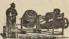
So wie hier der Hund Milchseparator und Butterfaß treibt, lassen sich in leichter Weise folgende Maschinen anhängen: Pumpe, Trieur, Schrot- und Pulvmühle, Rübenschneider, Knochenbrecher, Eiszerkleinerer, Fleischschneider, Schleifsteine, Gebläse, Säge, Drehbank, Bohrmaschine, Waschmaschine, Mischwerke u. a. m. Wie die vielen Dank- und Anerkennungsschreiben beweisen (siehe Nr. 10 und 11 nach), kommt der geringe Anschaffungspreis gar nicht in Betracht.
