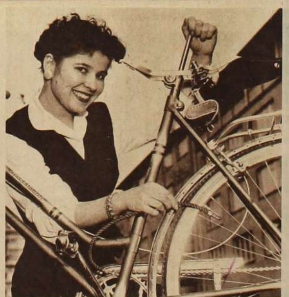
„Luftpumpe eingebaut“ wird es künftig bei der Anpreisung der Vorzüge eines Fahrrades heißen, seit eine Frankfurter Firma diese Neuerung herausbrachte. Der Pumpengriff liegt unter dem abklappbaren Sattel, die Hülle ist ein Teil des Rahmens.
