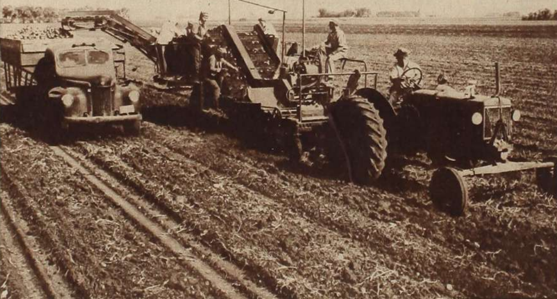
Aus der Erde direkt in das Lastauto gelangen die Kartoffeln mit Hilfe der neuen, derzeit in den USA üblichen Erntemaschinen. Je nach der Sorte, der Beschaffenheit des Bodens und des Kartoffelkrautes und dem Grad der Reife beträgt die Tagesleistung 700 bis 1700 Hektoliter.
