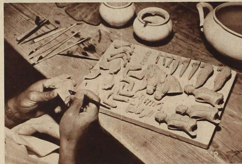
Zum „Retuschieren“ kommen die einzeln gegossenen Teile der Reiterfigur (Bild oben), nachdem sie als „Rohlinge“ aus den Gießformen herausgenommen wurden. Bild unten: Bemalen der zusammengesetzten Figur mit Porzellan-Schmelzfarben.
