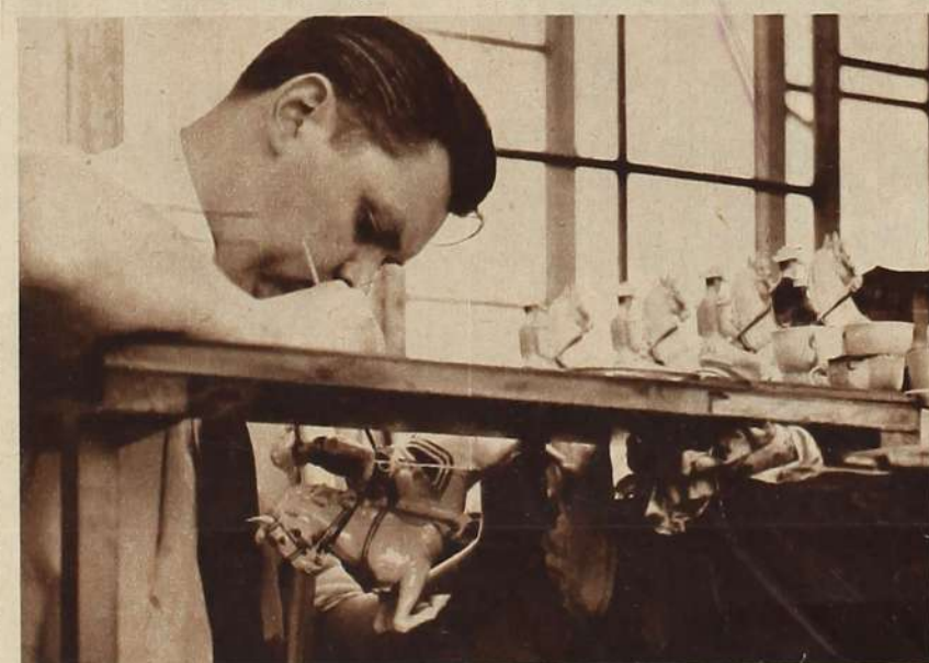
Zum „Retuschieren“ kommen die einzeln gegossenen Teile der Reiterfigur (Bild oben), nachdem sie als „Rohlinge“ aus den Gießformen herausgenommen wurden. Bild unten: Bemalen der zusammengesetzten Figur mit Porzellan-Schmelzfarben.
