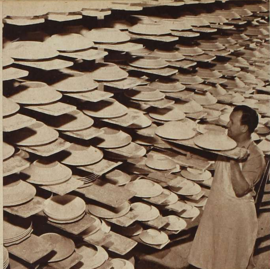
Teller werden handgedreht und nicht, wie das übrige Serviceporzellan, in Formen gegossen. Hier werden sie zum Trocknen auf Gipsformen aufgelegt. Die vorgesehenen Tellerränder sind bereits deutlich sichtbar.
