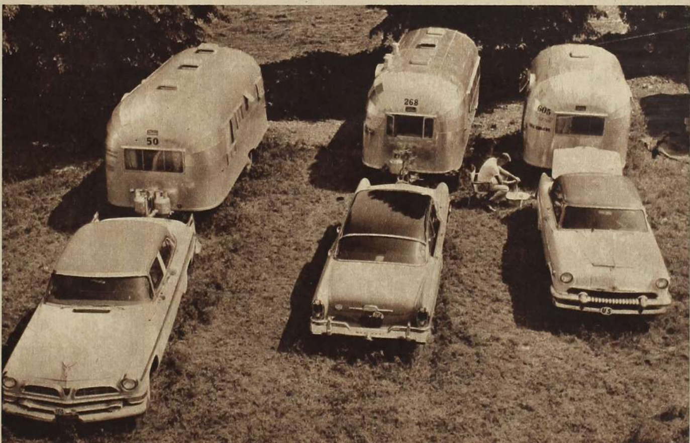
Auf dem Campingplatz von Rodaun bei Wien wurde dieses Teilbild von „Wally Byam's Caravan“ aufgenommen, das die stromlinienförmige, dem Flugzeugbau nachgeahmte Aluminiumverkleidung der Wohn- wagen veranschaulicht. Ihr Äußeres läßt kaum vermuten, wieviel modernen Komfort sie dem Reisenden bieten.
