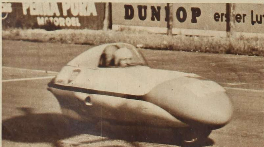
Ein Rekord an Sparsamkeit wurde mit diesem verkleideten 125 ccm-Motor- rad auf einer kürzlich veranstalteten Versuchsfahrt erreicht. Die Maschine benötigte für eine 100 km lange Strecke die unglaublich geringe Benzinmenge von 1,13 Liter.
