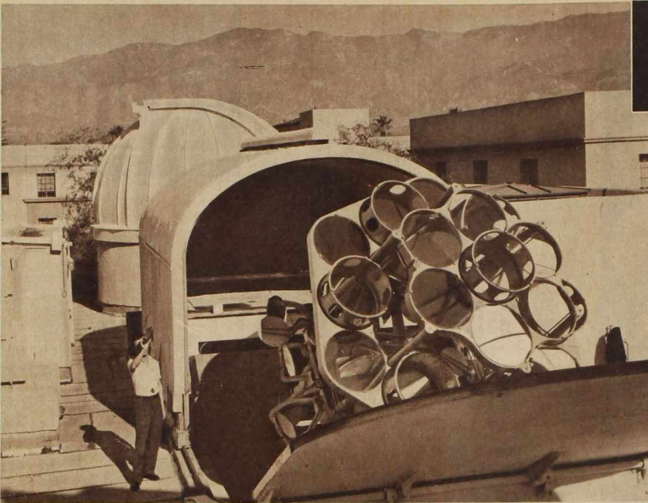
Wie ein riesiges Brennglas bündeln die 38 Linsen und 18 Spiegel des Sonnenofens die Sonnenstrahlen und erzeugen Temperaturen von mehr als 3000 Grad Celsius. Die Anlage, die in den Werkstätten der Technischen Hochschule von Kalifornien gebaut wurde, ist in ihrem fahrbaren Gehäuse auf der Kuppe eines Berges bei Pasadena untergebracht.
