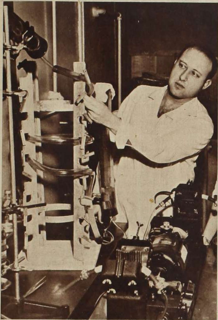
EINFACH UND BILLIG und trotzdem ein wertvoller Helfer des Herzchirurgen ist die künstliche Lunge, die von Wissenschaftlern der New Yorker Columbia-Universität zurzeit erprobt wird. Während die Ärzte am Herzen operieren, übernimmt der aus einem Röhren- und Membransystem und einer Pumpe bestehende Apparat die Versorgung der anderen Organe mit sauerstoffhaltigem Blut. Die Herstellungskosten des Gerätes belaufen sich, wie der Direktor der chirurgischen Versuchsstation, Dr. Ralph Deterling, erklärte, auf fünfzehn Dollar.
