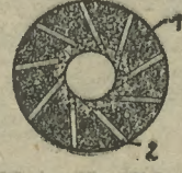
Abb. 1: Kunststein für Schrotmühlen. 1 = Mahlscheibe. 2 = Luftfurchen.
