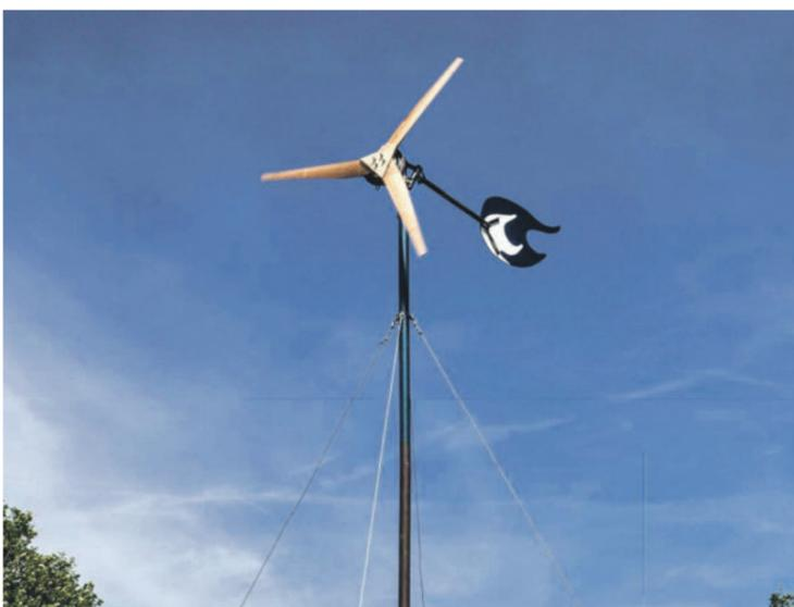
Im Workshop wird ein 2.2F Piggott windrad mit 2,2 Meter Rotordurchmesser und 550 bis 700 Watt Nennleistung gebaut.
